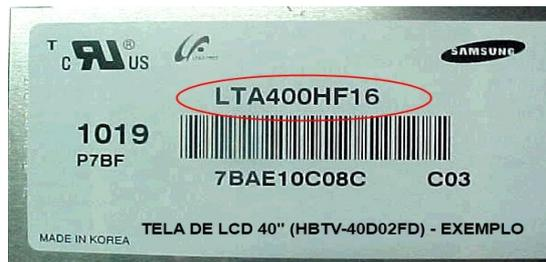
Fig. 8.2 - Identificação do painel de LCD pela etiqueta colada no verso (parte interna).
